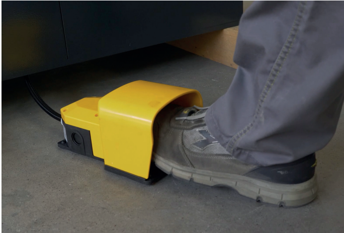
Sicherheitspedal zum Antreiben /Blockieren der Klinge Safety pedal to drive/block the blade
